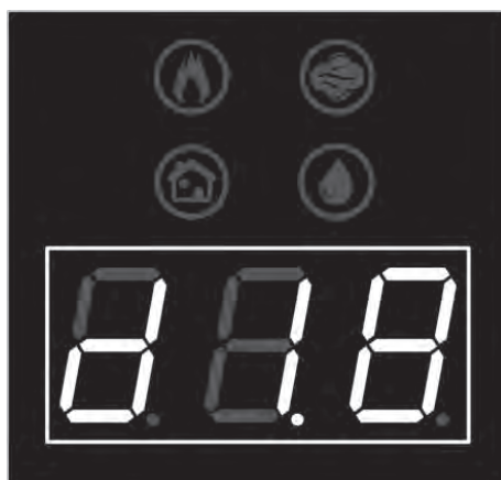
Рисунок 9 — Отображение давления в котле
